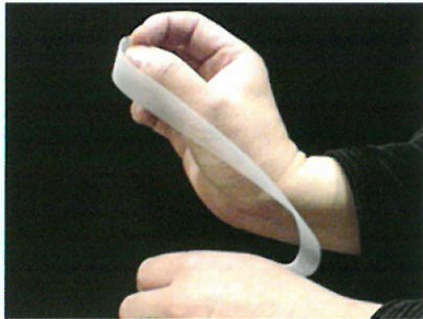
静電気を帯びた樹脂フィルムが、手にまとわり付いた状態。
