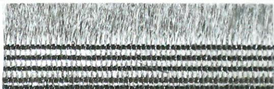
除電ブラシテープはコロナ放電式の除電布ブラシに導電性両面テープを加工した静電気除去製品です。アクリル繊維・ナイロン繊維に硫化銅を化学結合させた有機導電性繊維を使用しており、ステンレス・炭素繊維に比べ柔軟性があり、折れにくく、取り付け形状にフレキシブルに対応可能で静電気を除電できます。
