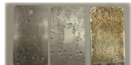
ASTM 水噴霧試験 アクサテック(左・中) 200時間クリア 塗布なし 50時間錆発生(右)
